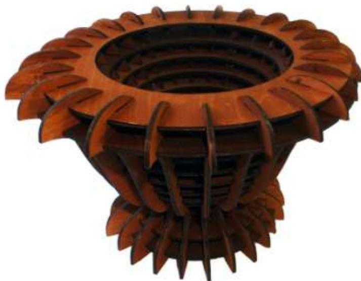
Рисунок 1. Ваза. Материал – фанера, технология лазерной резки
